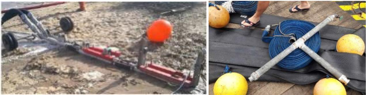
Figure 7 : Ensouillage par jetting avec outil tracté de type « Worm » sur navire petit fond à gauche et avec lance à eau opérée par plongeur à droite (Source : Orange Marine)
