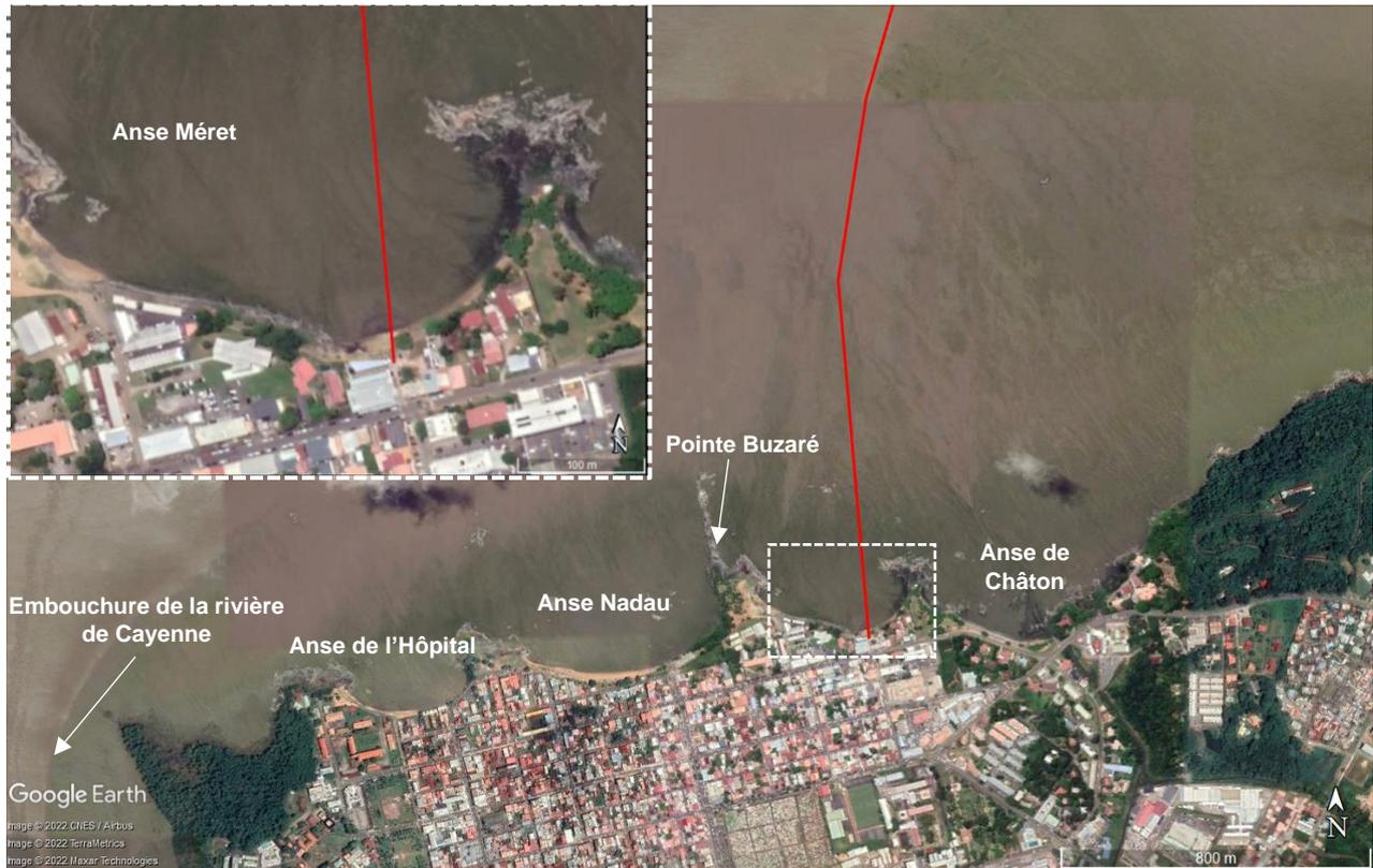
Figure 3 : Site d'implantation du câble DB1 au niveau de l'anse Méret avec zoom sur le site d'atterrissage (encadré)
